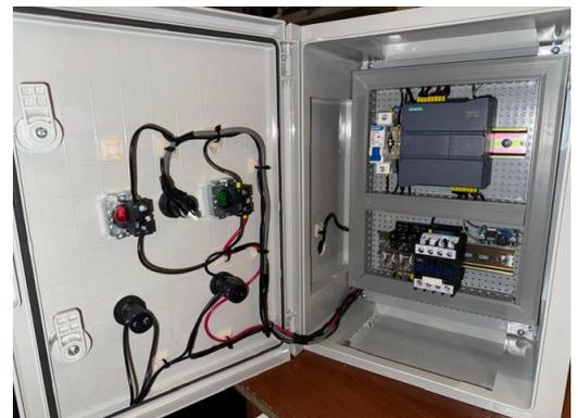
**Fig. 5** *Ensamblaje final del prototipo físico*
