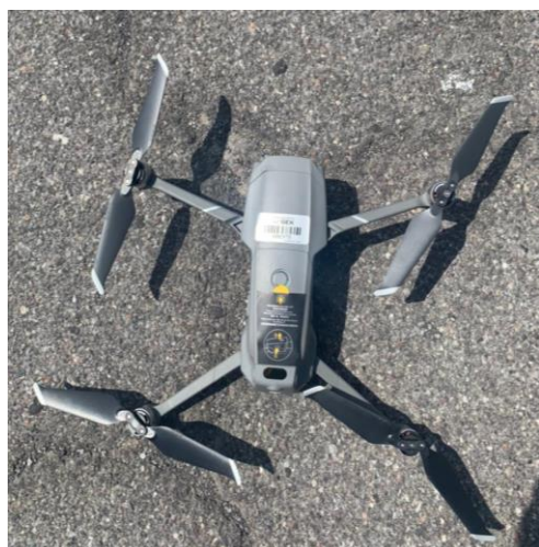
Figura 3. Aeronave pilotada remotamente (RPAS) empleada en la inspección estructural del Puente de Guayllabamba. El equipo es propiedad de la Universidad Internacional SEK Ecuador (fotografía de los autores).
